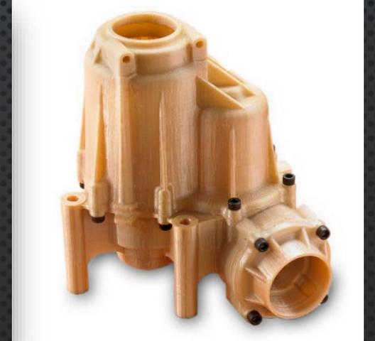
Le prestazioni sono state testate in condizioni di incendio. Per componenti stampati in 3D in grado di sopportare temperature fino a 220° ed esposizione a sostanze chimiche, la tecnologia di modellazione a deposizione fusa (FDM, Fused Deposition Modeling) viene utilizzata con materiali termoplastici PPSF/PPSU ad elevate prestazioni. Tale tecnica viene utilizzata per la produzione interna di prototipi automotive di motori oppure per dispositivi medicali sterilizzabili
